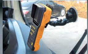
Das ist praktisch: Ösen zur Befestigung eines Nackenbandes sind ebenso vorhanden wie ein ausklappbarer Standfuß, ein Gürtelclip sowie die Möglichkeit, den TWN mit einer KFZ-Halterung zu nutzen.
