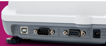
Die integrierten Anschlüsse bieten vielseitige Erweiterungsmöglichkeiten: Zusatzanzeige, Drucker und zur PC-Verbindung.
